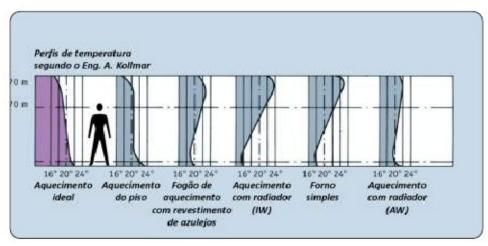
Se o planeador ou o empreiteiro pedir um piso radiante MULTIBETON, querem também superfície com uma uma temperatura saudável agradável. Α média da de 24°C. temperatura é No entanto, as pessoas com pés preferem sensíveis frio temperaturas superiores (aprox. 26°C) nos revestimentos de pavimentos boa com uma condutividade térmica tijoleira). Com tapetes (menor condutividade térmica), pessoas já se sentem muito confortáveis com temperaturas de aprox. 23°C.
